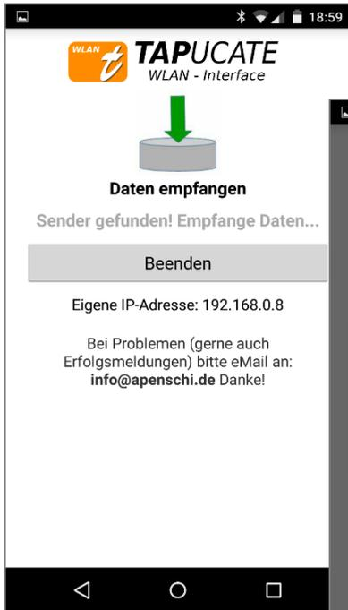
Das Zielgerät sucht dann automatisch das sendende Gerät im heimischen, gleichen WLAN-Netz anhand der IP-Adressen. Diese wird auch bei dem sendenden Gerät angezeigt.
